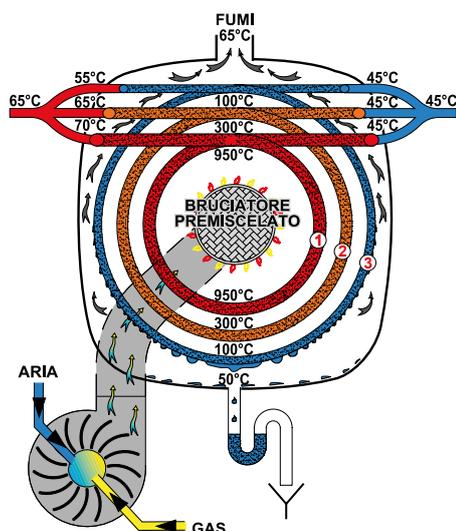
Durante il funzionamento, l'acqua di ritorno si ripartisce sulla serie di spire. Il vantaggio di tale sistema è di condensare con temperature dell'acqua di ritorno di 55/56°C e di ottenere ottimi rendimenti del generatore anche in impianti a radiatori. La circolazione del fluido è radiale ripartita e permette lo scambio termico fumi/acqua in controcorrente determinando un'efficienza elevata che porta velocemente i fumi alla condensazione.
